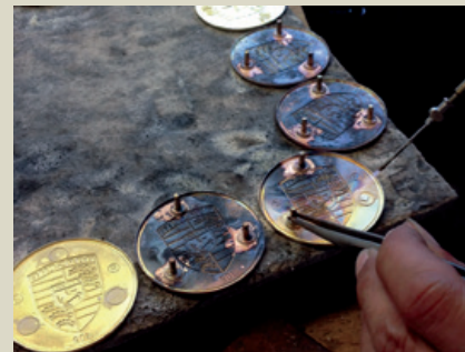
Hartlöten der Stifte nach Ausstanzen der Platine.
